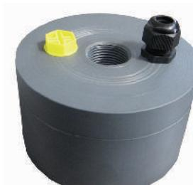
**PVC GLAVE ZA ZAPIRANJE VODNJAKA** na potisk, z luknjo na sredini, pokrovčkom in kabelsko uvodnico. V primerjavi z običajnimi glavami za zapiranje so cenejše in se hitreje nameščajo, ker nimajo vijakov in matic; izolacija vodnjaka od zunanjega okolice je zagotovljena z gumijastim tesnilom (o-ring) na notranji strani.
