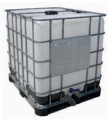
**TANK IZ HDPE** za transport tekočin, z zunanjim kovinskim ogrodjem, opremljen z zgornjo dojavljeno odprtino Ø 135 mm, ki je zaprta s tesnilnim pokrovom, in s spodnjo dojavljeno odprtino Ø 50 mm s pipo. Prostornina 1000 l; mere: višina 116,30 cm, podstavek 120 x 100 cm.
