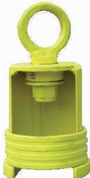
**ZVONASTI ELEMENT ZA DVIGANJE IZ JEKLA**, primeren samo za cevi z razširivijo (z navoji ali brez). Ob dvigu ušesa se element za dviganje zapre pod razširjenim delom cevi.
