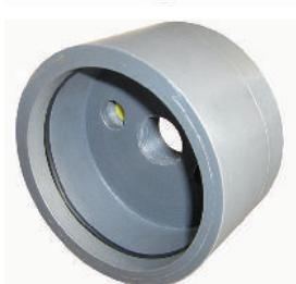
**NYOMÁSSAL RÖGZÍTHETŐ PVC KÚTZÁRÓ FEJEK**, nyomással rögzíthető, középső furattal és kábelátvezetővel. A normál kútzáró fejekhez képest az áruk alacsonyabb, és gyorsabban felhelyezhetők, mivel nincsenek csavarjaik és anyacsavarjaik, a kút külső környezettől történő szigetelését egy belül elhelyezett gumigyűrű (O-ring) biztosítja.
