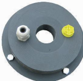
**PVC GLAVE ZA ZAPIRANJE VODNJAKA** z luknjo na sredini, pokrovčkom in kabelsko uvodnico. Glava je sestavljena iz prirobnice in nasprotne prirobnice, ki sta spojeni in pritrjeni z vijaki in maticami; uporablja se za zaščito vodnjaka pred morebitnim onesnaženjem.
